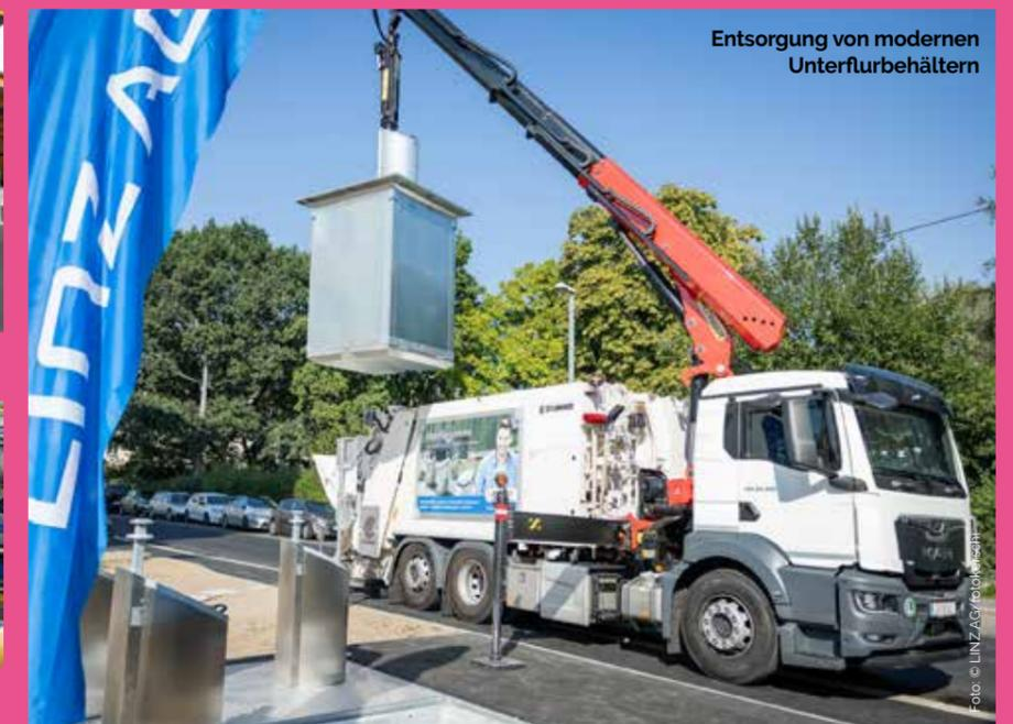
Entsorgung von modernen Unterflurbehältern
