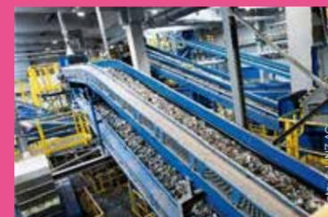
Sortieranlage Reststoffaufbereitungsanlage (RABA)
